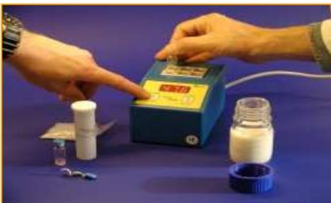
Posizionare le fiale nell'incubatore preriscaldato a 47,5°C e lasciarle in incubazione per 3 minuti
