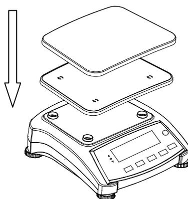
Figura 2-1. Installazione della sotto-piattaforma e del piatto metallico
