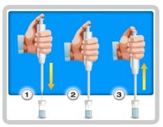
**3.** Inserire il campione nella cuvetta. Tenendo il puntale della pipetta immerso nel reagente, premere e rilasciare il pistone della pipetta più volte.
