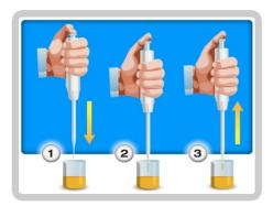
1. Avvinare la pipetta e prelevare con essa  $10~\mu L$  di campione. Per avvinare la pipetta: prelevare il campione con la pipetta e rilasciarlo su carta assorbente; ripetere l'operazione 2-3 volte.
