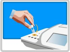
**5.** Inserire la cuvetta in una cella di incubazione ed avviare il timer premendo sull'icona.
