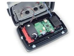
Utilizzando l'opzione analogica (4-20 mA o 0-10 V) e due ingressi/quattro uscite I/O discreto, il nuovo indicatore Defender 5000 può essere utilizzato anche per i sistemi PLC.
