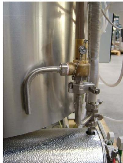
**Figura 1.7.2.b - Valvola sicurezza generatore**
