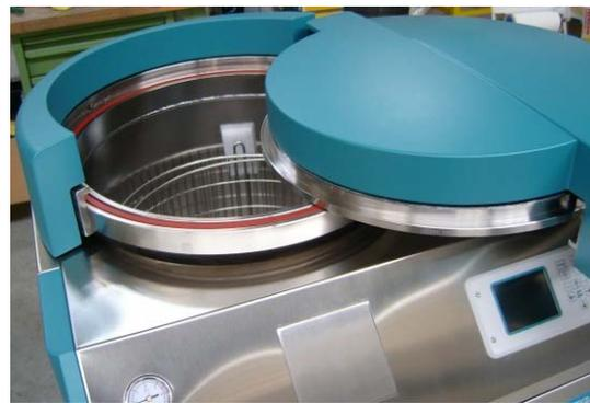
**Figura 1.4.2.d - Sistema di tenuta coperchio Guarnizione di tenuta**
