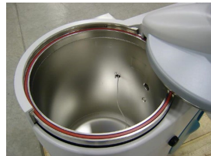
Figura 1.4.2.d - Sistema di tenuta coperchio Guarnizione di tenuta
