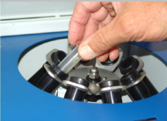
Caricare la centrifuga inserendo le due provette in posizioni contrapposte del rotore e avviare la macchina impostando una velocità di **4500 giri/minuto** per un tempo di **5 minuti** (i valori sono indicativi)
