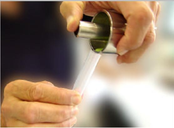
Versare il liquido nella provetta e, aiutandosi con la spatolina, trasferire tutto l'impasto ottenuto nella cuvetta per centrifuga
