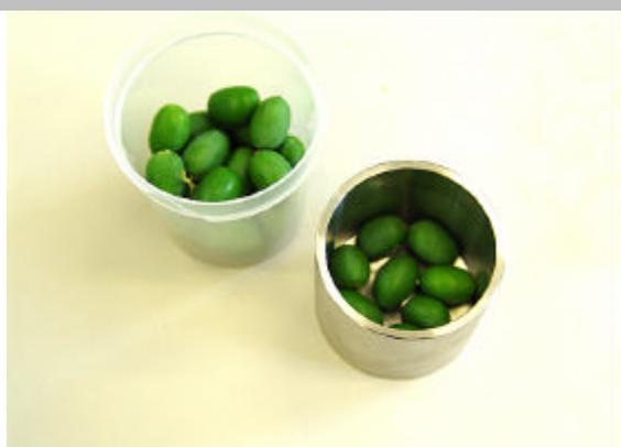
Inserire 5-10 olive (in funzione della dimensione dell'oliva e del contenuto di olio) nel contenitore grande
