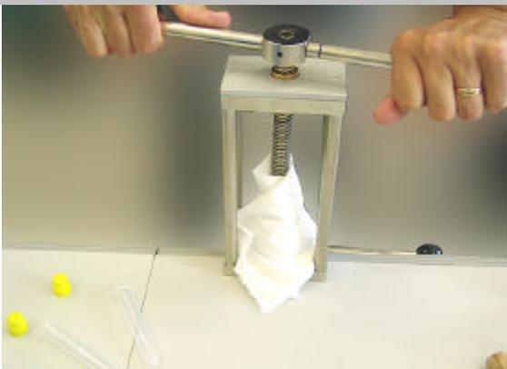
Rivestire il contenitore con carta assorbente per evitare che eventuali schizzi raggiungano l'operatore e ruotare le leve in direzione oraria
