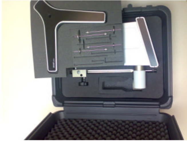
Fig 1. Il viscosimetro nella sua valigetta (Da richiedere come accessorio)
