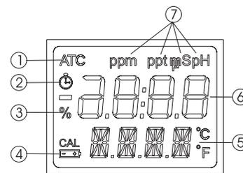
1. indicatore di compensazione automatica della temperatura (ATC)
