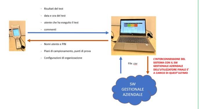
Durante il nostro sopralluogo è stato possibile prendere visione del funzionamento del sistema 3M Clean Trace Luminometro e di appurarne, oltre che l'effettivo funzionamento, la possibilità di scambio dei dati attraverso una tabella di frontiera (file .csv) che può essere utilizzata da sistemi informativi aziendali per la gestione dei dati in interconnessione.
