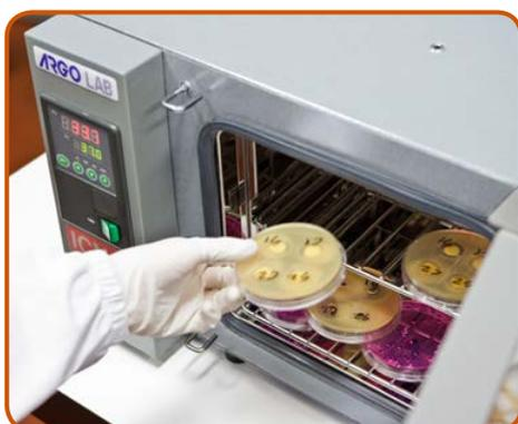
Per una migliore uniformità della temperatura, il sistema di riscaldamento a filo è posizionato su tutta la superficie delle pareti della camera.
