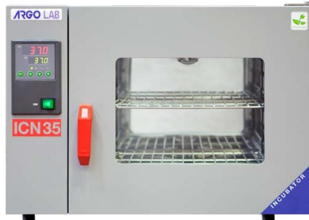
I materiali organici utilizzati nelle tipiche applicazioni di laboratorio necessitano di un riscaldamento costante e molto delicato. La distribuzione della temperatura negli incubatori Argolab è ottenuta senza circolazione forzata dell'aria ma utilizzandone solo la naturale convezione, che non stressa il campione e ne permette la crescita uniforme.
