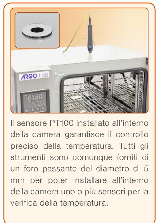
Il sensore PT100 installato all'interno della camera garantisce il controllo preciso della temperatura. Tutti gli strumenti sono comunque forniti di un foro passante del diametro di 5 mm per poter installare all'interno della camera uno o più sensori per la verifica della temperatura.
