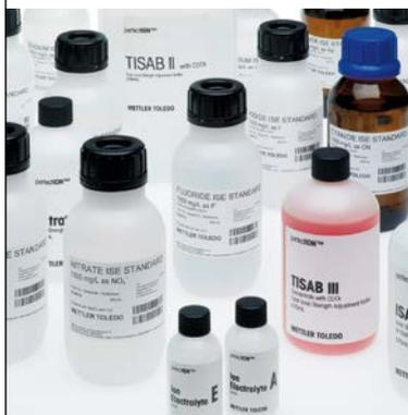
In tutte le procedure analitiche che utilizzano un ISE, prima della misurazione o della taratura è necessario aggiungere la quantità corretta di regolatore di forza ionica (ISA, Ionic Strength Adjustor) a tutti i campioni e standard. Nel manuale di ogni ISE sono disponibili le istruzioni divise per tipo e quantità di ISA.
