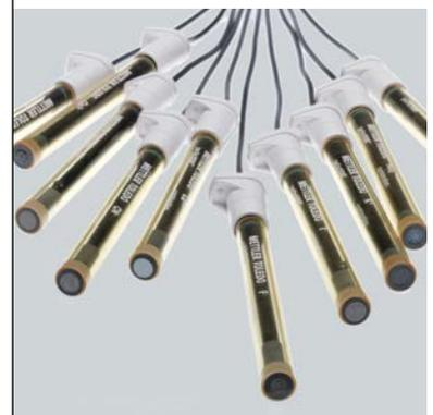
È importante assicurarsi di riempire l'elettrodo di riferimento di ogni ISE con la soluzione elettrolitica consigliata. L'elettrolita corretto ridurrà al minimo i potenziali di giunzione e fornirà la temperatura e la risposta temporale ottimali. Per prestazioni ottimali degli elettrodi, l'elettrolita deve essere riempito o sostituito regolarmente. Per ulteriori informazioni, consultare il manuale dell'elettrodo.
