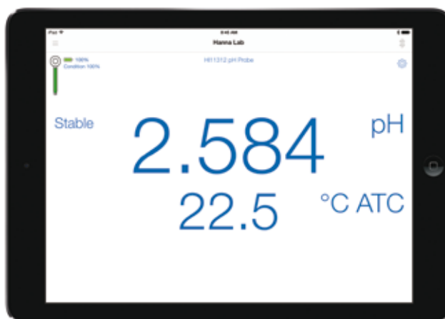
FIG.07- SCHERMATA DELL'APPLICAZIONE "HANNA LAB": VISUALIZZAZIONE DEI VALORI PH E TEMPERATURA
