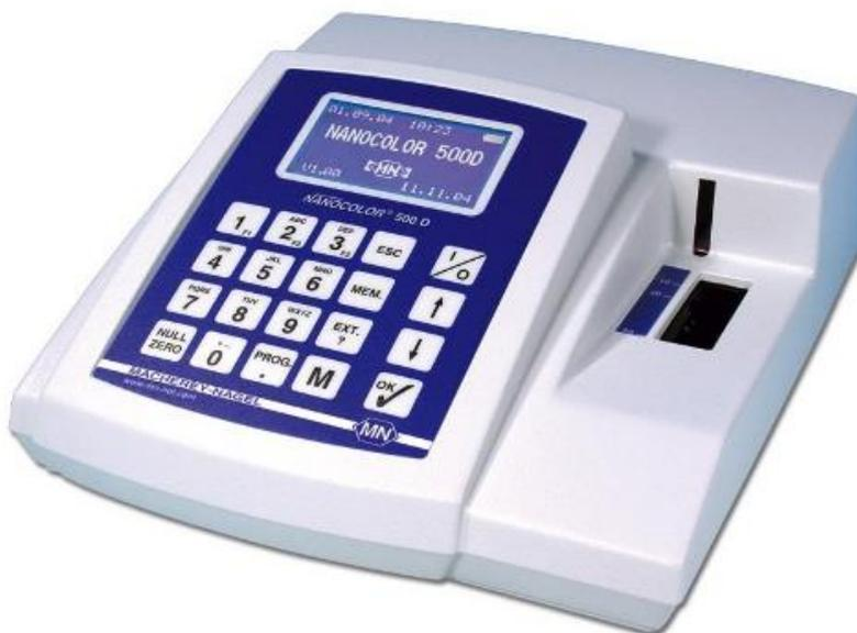
Munito di scanner per il **codice a barre**, effettua la selezione automatica dei metodi d'analisi, della lunghezza d'onda e la misurazione, semplicemente introducendo la provetta **NANOCOLOR®** nell'apposito alloggiamento. Il fotometro NANOCOLOR® 500 D è inoltre dotato di **10 filtri fissi** e **due alloggiamenti** per l'aggiunta di filtri aggiuntivi tra 340 e 860 nm.
