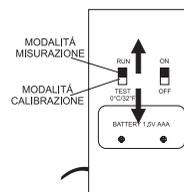
Il display visualizzerà la lettura  $0.0^{\circ}\text{C} \pm 0.3^{\circ}\text{C}$ ; questo significa che lo strumento rientra nelle specifiche di precisione indicate nella tabella a lato. Riposizionare l'interruttore su RUN; il display visualizzerà la misura di temperatura.
